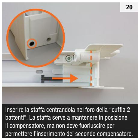
Inserire la staffa centrandola nel foro della "cuffia 2 battenti". La staffa serve a mantenere in posizione il compensatore, ma non deve fuoriuscire per permettere l'inserimento del secondo compensatore.
